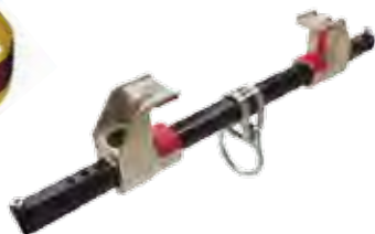
Mordaza ajustable de viga FP Stryder™ P/N 10051455 Capacidad de la pestaña 10.2 cm hasta 35.6 cm.
